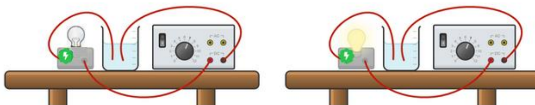
Σχήμα 2. Η πειραματική διάταξη περιλαμβάνει ηλεκτρική πηγή, λαμπτήρα και, σε σειρά, ποτήρι με απιοντισμένο νερό (αριστερά) και υδατικό διάλυμα \text{NaCl} (δεξιά).
